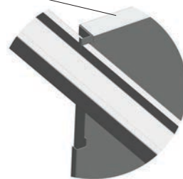
Versione B - Particolare pannello con gancio Version B - Panel detail with clip
